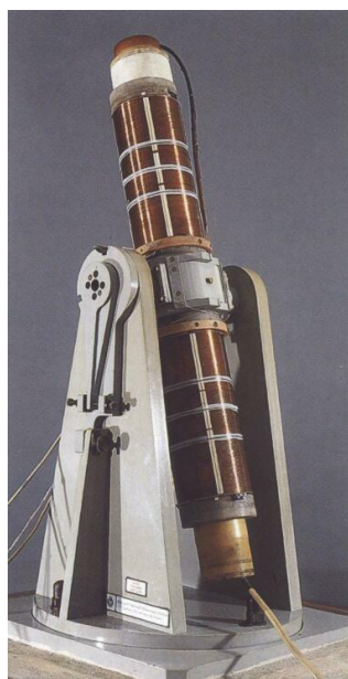
Рисунок 6.5 – Блок еталонної струмової котушки
