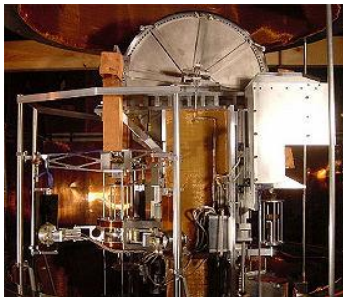
Рисунок 8.4 – Зовнішній вигляд ват-вагів
