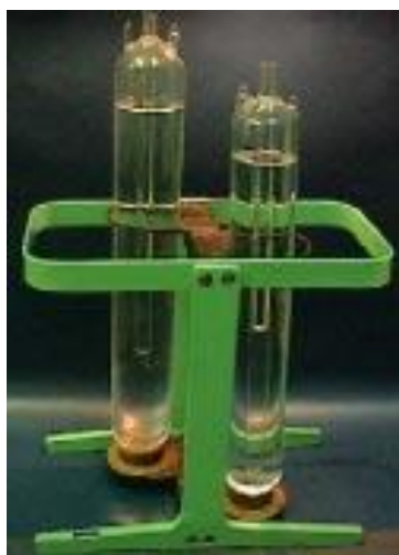
Рисунок 9.2 – Пристрій, що відтворює потрійну точку води
