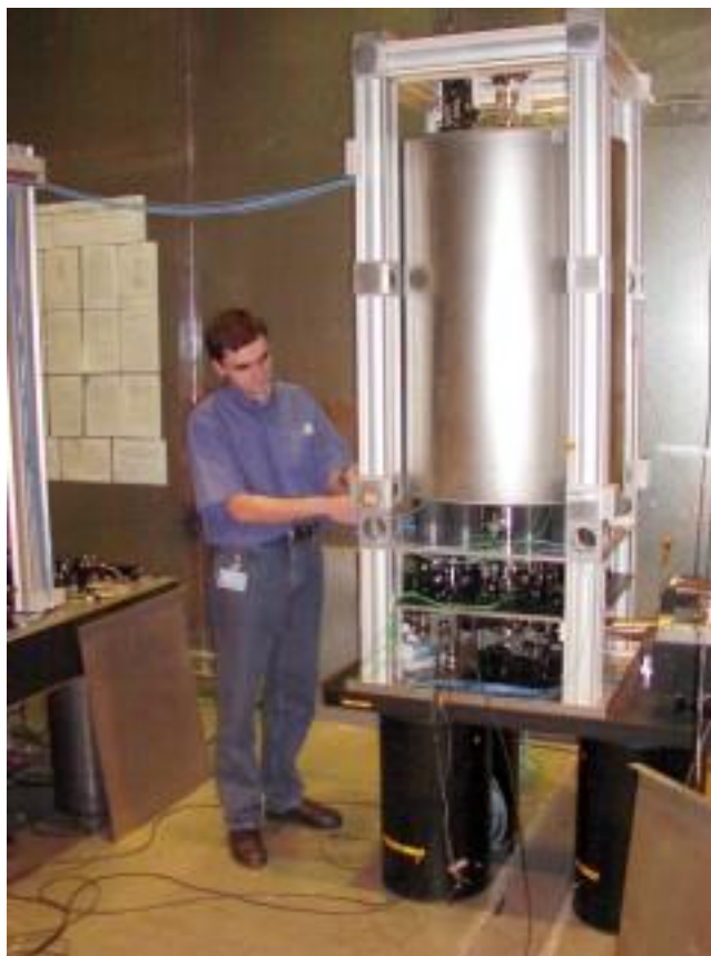
Рисунок 2.16 – Цезієвий фонтан NPL: а – структурна схема; б – зовнішній вигляд
