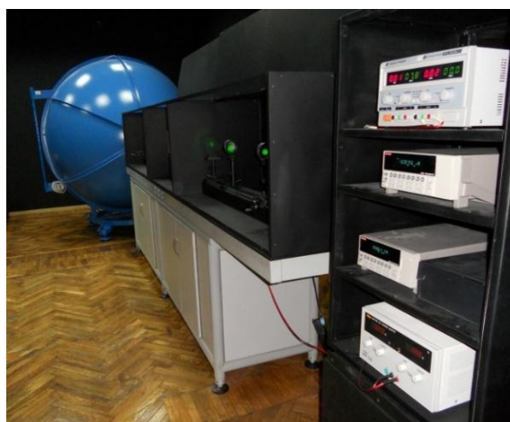
Рисунок 10.7 – Зовнішній вигляд еталона одиниці світлового потоку
