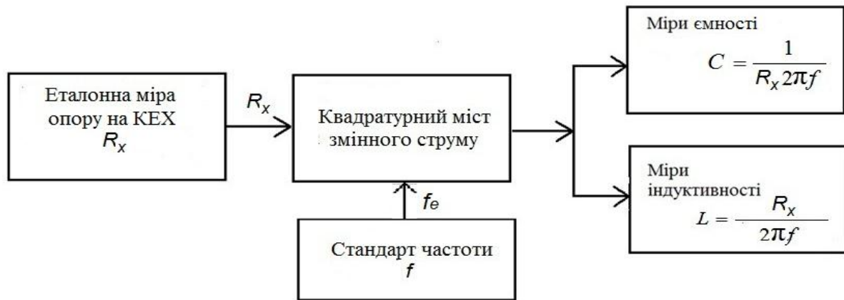
Рисунок 5.20 – Схема калібрування мір ємності і індуктивності за КЕХ
