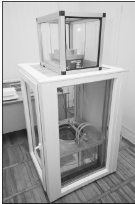
Комплекс оборудования, входящего в национальный эталон единицы массы Украины
